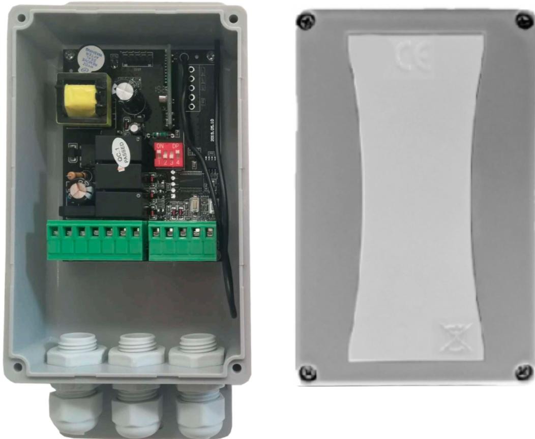
Cuadro de control monofásico de 100 a 250V AC para persianas enrollables, con receptor multimarca Rx Multi integrado para frecuencia 433 MHz. Entradas de pulsador arriba/abajo configurables como "hombre presente", orden directa o pulsador secuencial. Con cierre automático disponible y entrada de fotocélula y lámpara.
